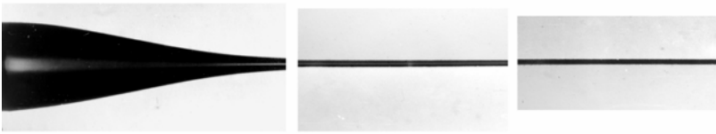
Рис.4. Фотографии фрагментов струи полимерной жидкости на разных расстояниях от капилляра диаметром 1 мм. Первый кадр слева - профиль струи вблизи капилляра. Второй и третий кадры - контур струи на расстоянии 2 см и 4 см от капилляра соответственно. Напряженность поля 5.6 \cdot 10^6 В/м, расход 8.3 \cdot 10^{-3} см 3 /с, электрический ток, переносимый струей 7.2 \cdot 10^{-8} А
