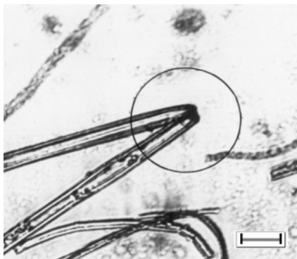
Рис.10. Продольное деление струи. Предраспадная конфигурация волокна, длина масштабного деления 20 мкм
